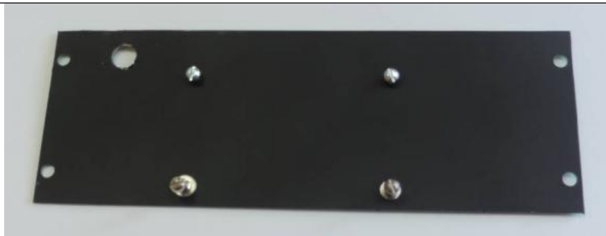
Рисунок В.3 - Стальная пластина с четырьмя винтами М4, вынутая из корпуса
