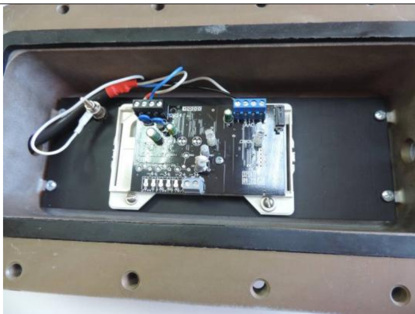
Рисунок В.10 – Модуль (без крышки) на пластине установлен в корпус
