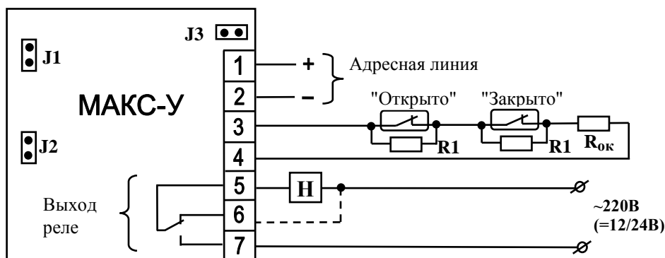
Рис.2. Схема подключения нормально-выключенной нагрузки.
