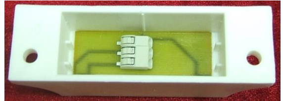
ДПМ-2 исп.03/2 клеммы экспрессмонтажа, Wago
