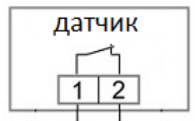
(контакт 1 и 2 размыкаются под действием магнита)
