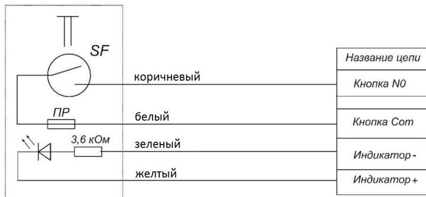
Рис.2 маркировка выводов BK200 (кнопка)
