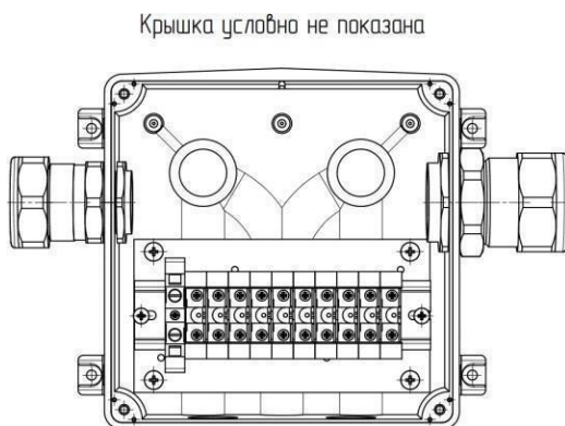
Рис. 2 Коробка с клеммами УТJ5-16 и шиной заземления.
